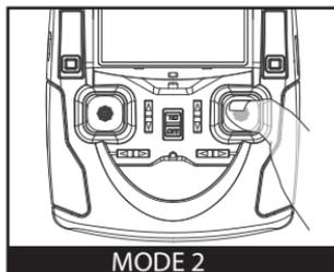
По умолчанию при включении Q4 активируется нормальный режим полета. Чтобы повысить маневренность и скорость реакции Q4 на управление, вы можете активировать режим «Эксперт»: Чтобы включить/выключить режим «Эксперт» примерно на 0,5 сек нажмите сверху вниз на ручку тангажа. Когда активируется режим «Эксперт» раздается два звуковых сигнала «Биип», а на ЖК-экране передатчика отображается надпись «EXPERT MODE».
